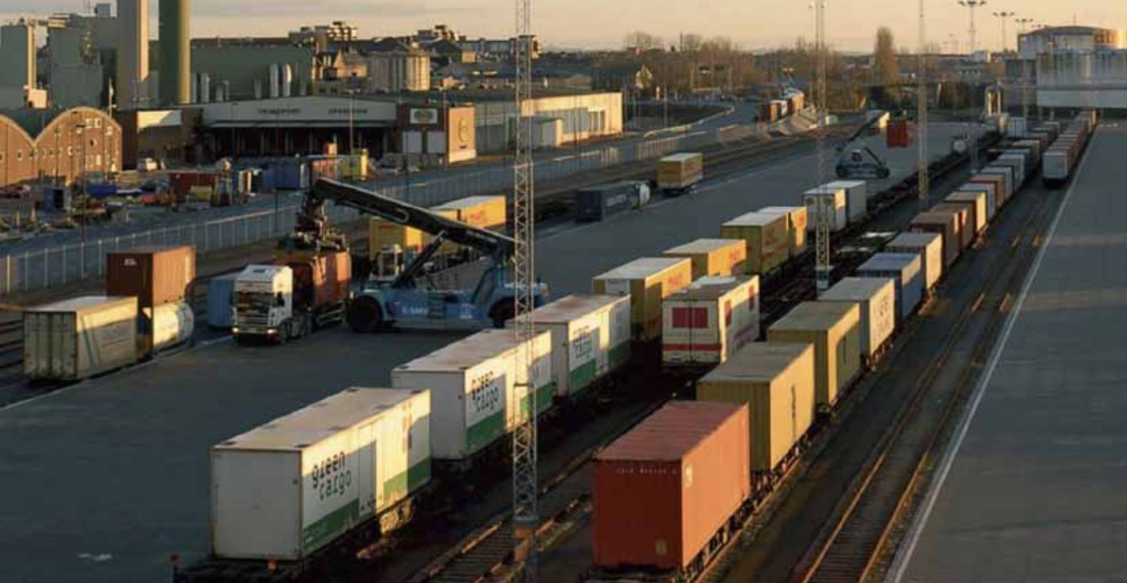
Vid Combiterminalen omlastas containrar och trailrar snabbt och effektivt mellan lastbil, tåg och fartyg. Combiterminalen ökar tågtransporter och minskar lastbiltransporter. Under ett år rullar närmare 60 000 lastenheter på järnväg ut och in via Combiterminalen och sparar därmed vår miljö på lastbiltransporter. Foto: Helsingborgs Hamn.
